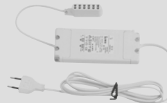
Varenr. 09245 Elektronisk trafo inkl. AMP-stikdåse med seks stik. Kan tilkobles 2-6 stk. 10W indbygningsspot eller 1-3 stk. 20W spots. 60W/250 volt.
